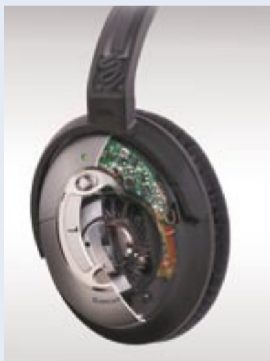
In den QuietComfort 15 Headphones kommt eine Elektronik zum Einsatz, bei der die Mikrofone innen und außen an der Ohrmuschel liegen. Das System registriert alle Umgebungsgeräusche und erzeugt ein entsprechendes Gegensignal.
