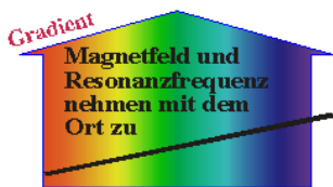
Abbildung 1.19: Ortsabhängige Resonanzfrequenz in einem inhomogenen Magnetfeld.
