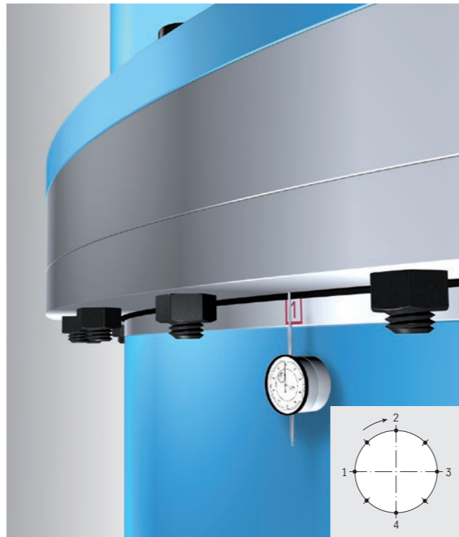
Figura 6: Struttura di principio della misurazione del gioco al ribaltamento
