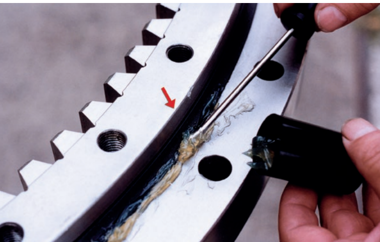
Figura 16: Prelievo di grasso dal labbro di tenuta
