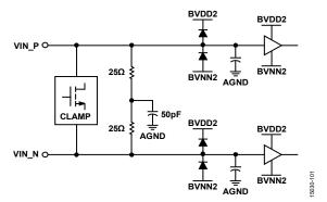
Figure 77. Analog Inputs
