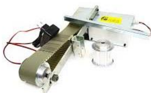
Ossigenatore per emulsioni Oxygenator for emulsion
