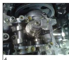
Po zamocowaniu narzędzia na wtryskiwaczu, przykręcić sworzeń z przyrządem do wybijania do kołka M10 i przystąpić do wyciągania wtryskiwacza, działając ręcznie za pomocą przyrządu do wybijania (fig. 9).
