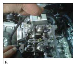
Nachdem das Werkzeug auf dem Einspritzventil befestigt ist, den Stift mit dem Schlagwerkhammer (mit Korn M10) festschrauben und das Einspritzventil manuell mit Hilfe des Schlagwerkhammers abziehen (Abb.9).
