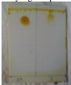
Gambar 7. Kromatogram asam lemak amida standar ( R_f 0,86) dan asam lemak amida hasil sintesis ( R_f 0,88)
