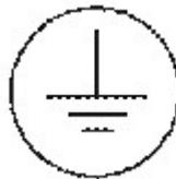
**NOTA Figura 250-126** Un ejemplo de un símbolo utilizado para identificar el Punto de Terminación de la Puesta a Tierra para un Conductor de Puesta a Tierra.
