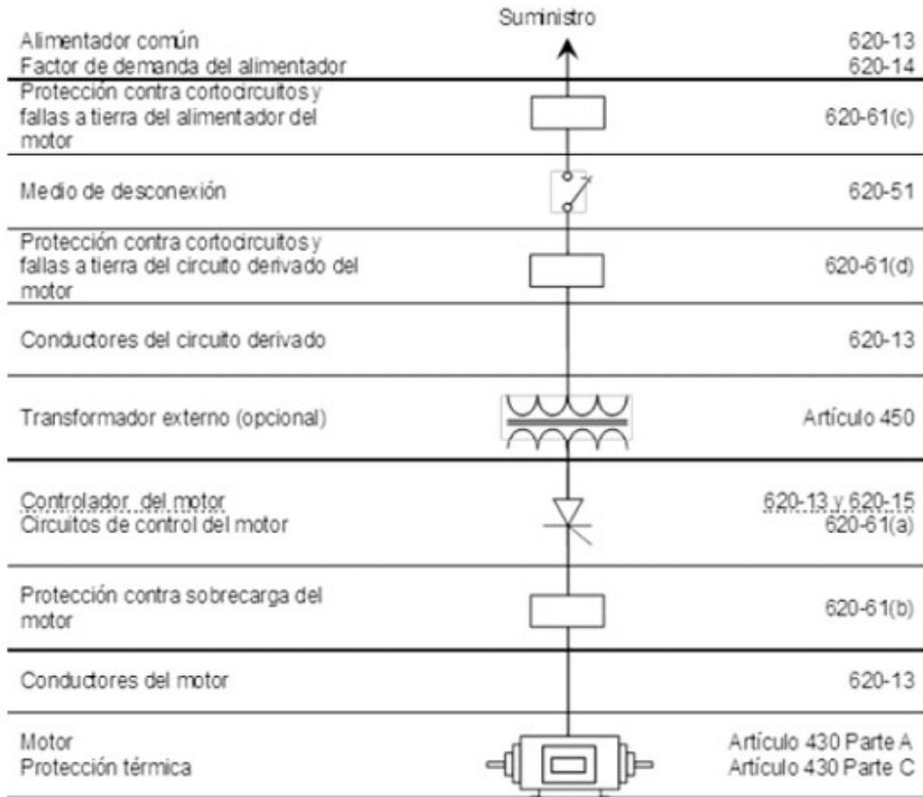
**Figura 620-13.- Diagrama unifilar**
