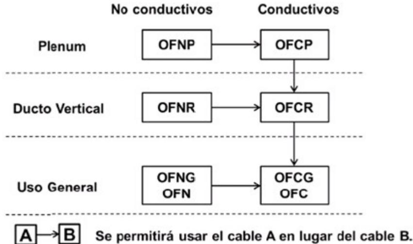
Figura 770-154.- Jerarquía de la sustitución de cables
