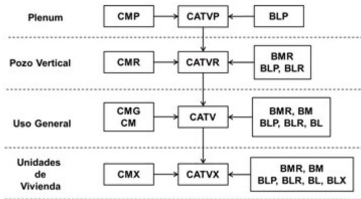
**A** → **B** Se permitirá usar el cable coaxial A en lugar del cable coaxial B
