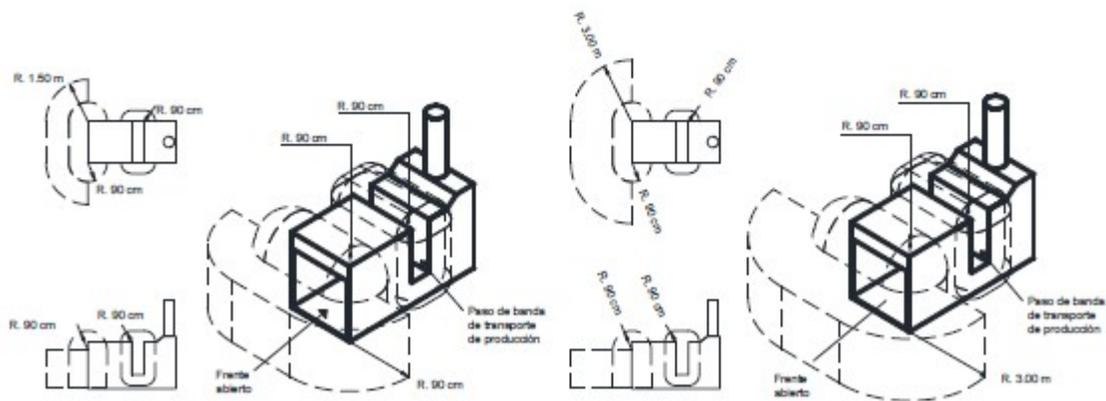
Figura 516-3(c)(2).- Areas Clase I, División 2; Clase I, Zona 2 o Clase II, División 2 adyacentes a un recinto o una cabina del rociado cerrados por arriba, abiertos por la cara o abiertos por el frente
