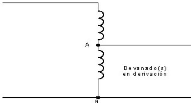
**Figura 450-4.- Autotransformador**
