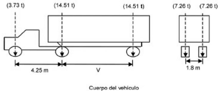
V = Dimensión que varía entre 4.25 y 9.00 metros La dimensión a usar debe ser aquella que dé por resultado (La carga lateral y vertical que produzca los máximos momentos flexionantes en la estructura)
