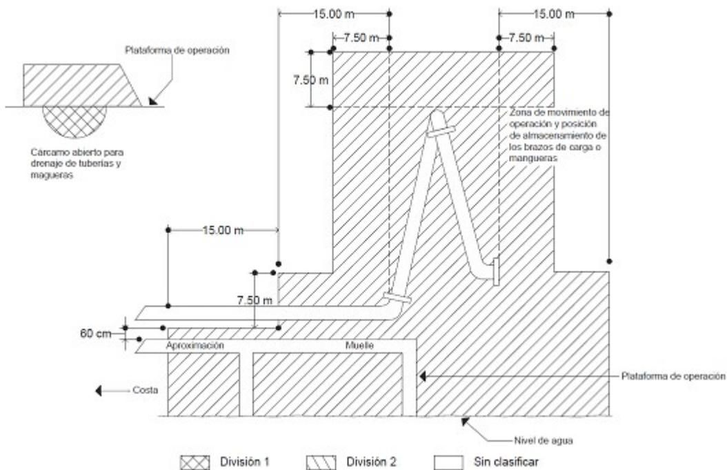
1) La "fuente de vapor" es el área que rodea a todo el movimiento del brazo de carga durante la operación normal y en la posición de almacenamiento o descanso en la zona de la brida de conexión final del brazo de carga (o manguera).
