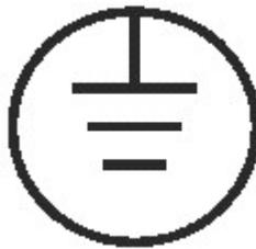
**NOTA:** Figura 406-10(b)(4) un ejemplo de un símbolo utilizado para identificar el punto de terminación de un conductor de puesta a tierra de equipos.
