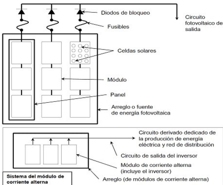
1. El propósito de estos diagramas es el de servir como un medio de identificación de los compañeros de los componentes, circuitos y conexiones de un sistema fotovoltaico
