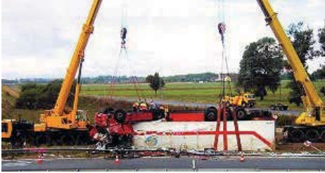
Abb. 9: Aufrichten eines verunfallten Lkw mit Fahrzeugkranen
