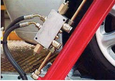
Abb. 18: Entsperrbares Rückschlagventil (Lasthalteventil) an Doppelstockplateau
