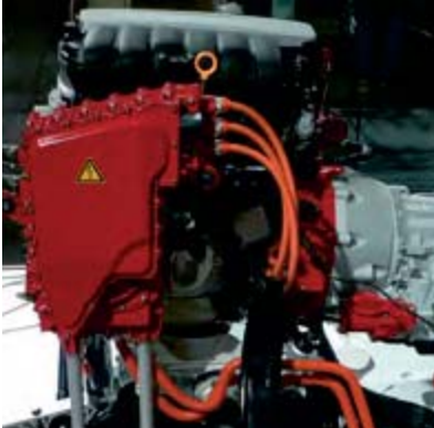
Bild 5: Basisschutz durch Isolation und Abdeckung
