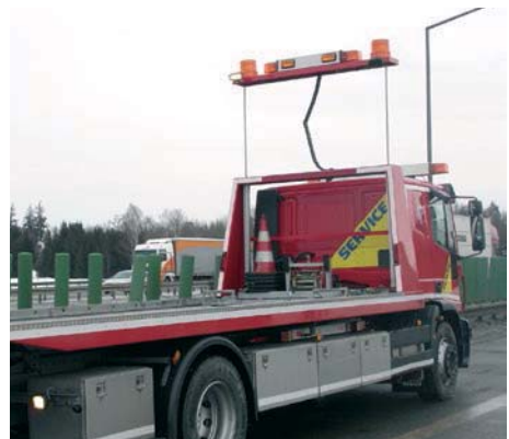
Abb. 7 Teleskopierbare, weit sichtbare Warnleuchten
