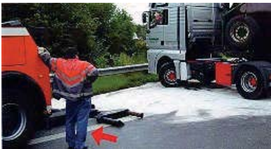
Abb. 39: So nicht! Immer vollständige Warnkleidung und Sicherheitsschuhe tragen!
