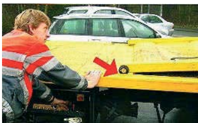
Abb. 14: Quetschstellen zwischen sich bewegendem Doppelstock- und unterem Plateau
