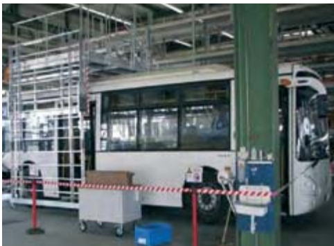
Bild 8: Beispiel für Absichern des Arbeitsbereichs bei Prüfarbeiten
