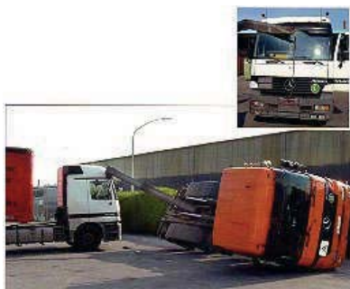
Abb. 40: Unzulässiger Einsatz eines Abrollkippers
