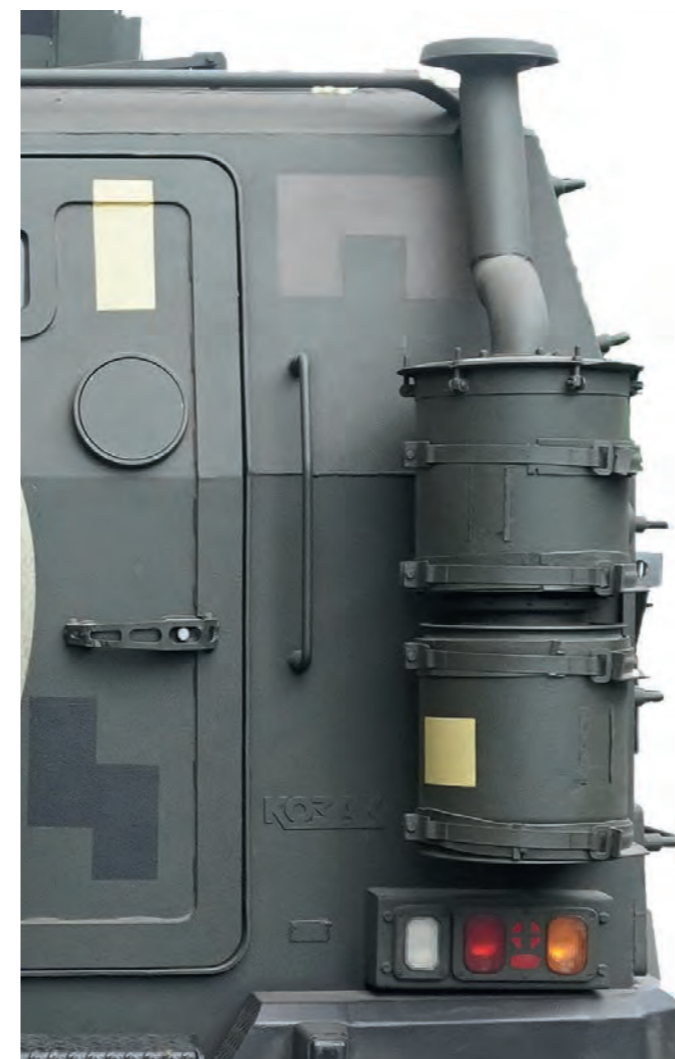
Фільтровентиляційна установка CBRN device
