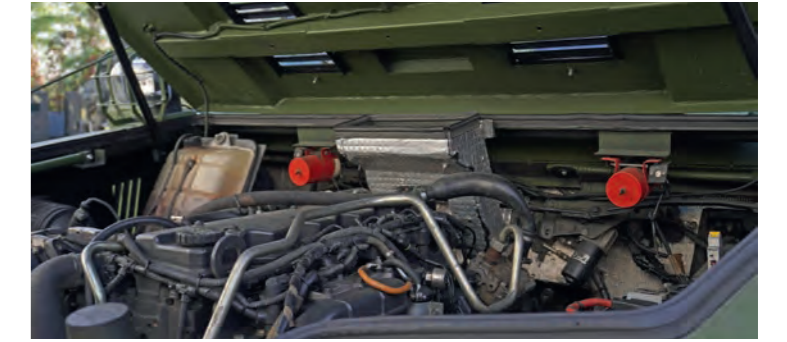
Система пожежогасіння відсіку двигуна Engine compartment fire suppression system
