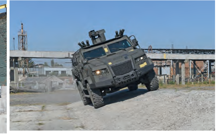
Кут їзди під боковим уклоном 30 % 30% side slope
