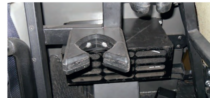
Додатковий випарник системи кондиціонера у відділенні десанту Additional AC evaporator of crew compartment
