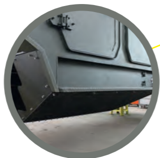
V-подібне днище V-shaped hull
