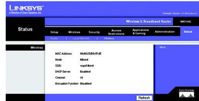
Figuur 5-49: Tabblad Status - Wireless (Draadloos)
