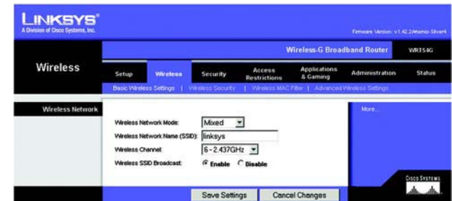
Figura 5-17: Ficha Wireless (Inalámbrico) - Basic Wireless Settings (Parámetros inalámbricos básicos)
