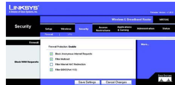
Figura 5-27: Separador Security (Segurança) - Firewall
