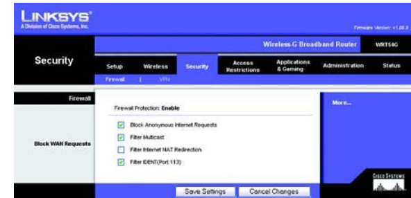
Figur 5-27: Fliken Security (Säkerhet) – Firewall (Brandvägg)
