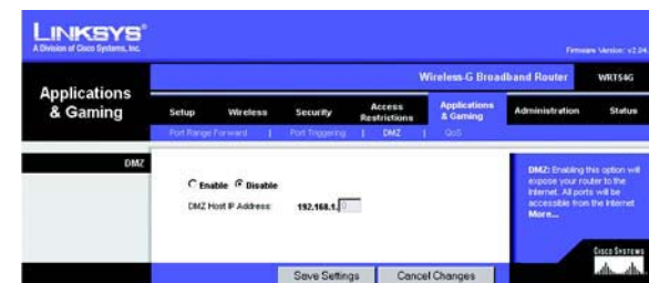
Figur 5-36: Fanen Applications and Gaming - DMZ (Programmer og spil - DMZ)
