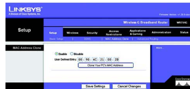
Figura 5-14: Scheda Setup (Configurazione) - MAC Address Clone (Clonazione indirizzo MAC)
