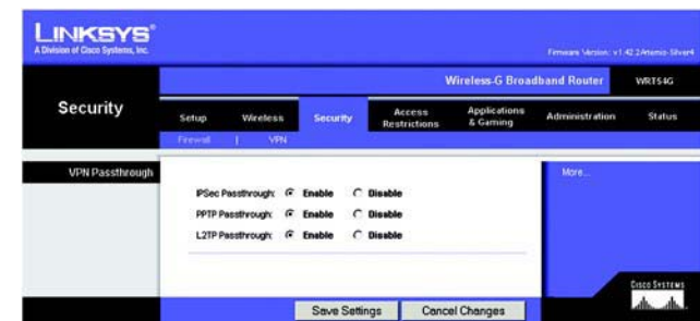
Figura 5-28: Separador Security (Segurança) - VPN Passthrough (Passagem VPN)
