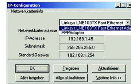
Abbildung E-1: Fenster IP-Konfiguration
