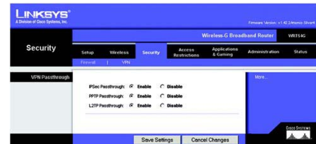
Figur 5-28: Fliken Security (Säkerhet) – VPN Passthrough (VPN-genomströmning)
