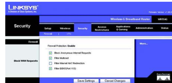
Figura 5-27: Scheda Security (Sicurezza) - Firewall
