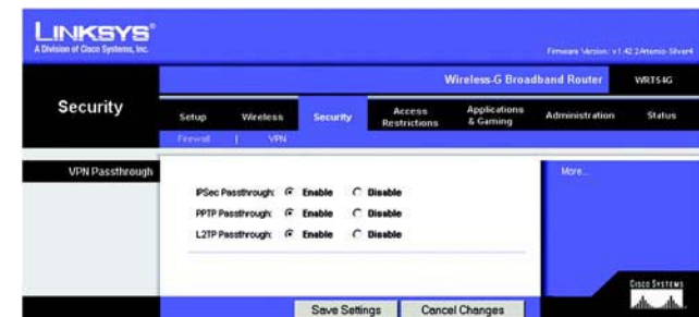
Figuur 5-28: Tabblad Security (Beveiliging) - VPN Passthrough (VPN-doorvoer)
