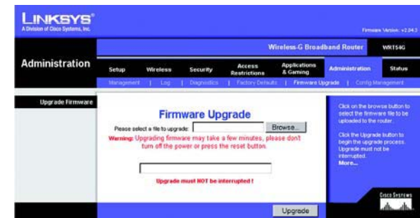
Figura 5-44: Ficha Administration (Administración) - Firmware Upgrade (Actualización del firmware)
