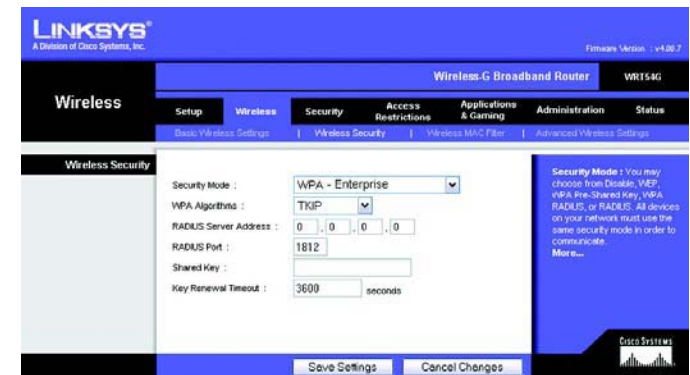
Figur 5-19: Fanen Wireless - Wireless Security (WPA Enterprise) (Trådløs - Trådløs sikkerhed (WPA Enterprise))
