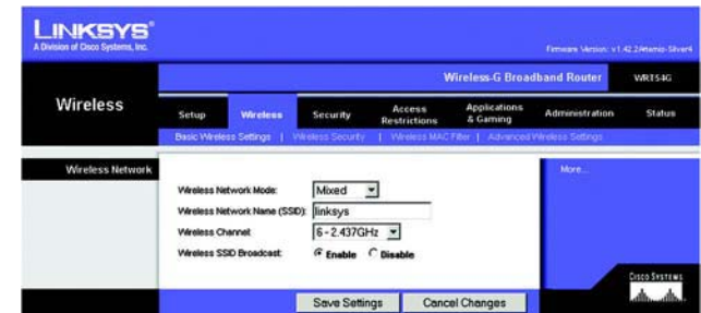
Figuur 5-17: Tabblad Wireless (Draadloos) - Basic Wireless Settings (Standaardinstellingen voor draadloos netwerk)
