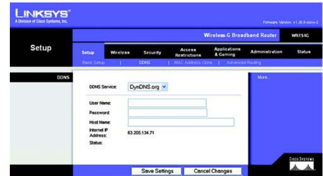
Figur 5-13: Fanen Setup - DDNS (Konfiguration - DDNS)
