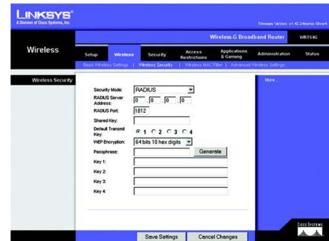
Figura 5-22: Ficha Wireless (Inalámbrico) - Wireless Security (RADIUS) (Seguridad inalámbrica, RADIUS)
