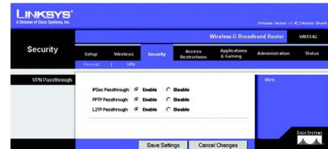
Figura 5-28: Ficha Security (Seguridad) - VPN Passthrough (Paso a través de VPN)
