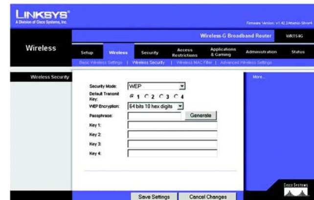
Figur 5-23: Fliken Wireless (Trådlöst) – Wireless Security (Trådlös säkerhet) (WEP)
