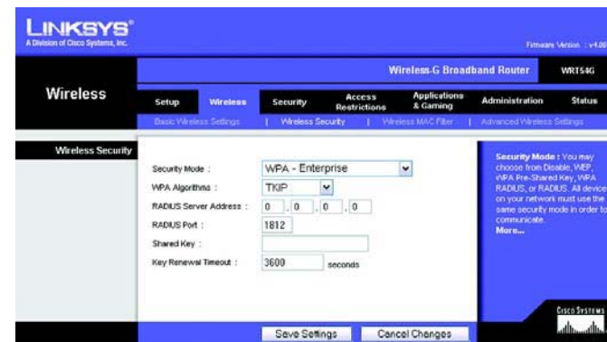
Figura 5-19: Separador Wireless (Sem fios) - Wireless Security (WPA Enterprise) (Segurança sem fios (WPA Enterprise))
