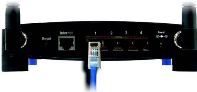
Figure 4-2 : Connexion de vos périphériques réseau
