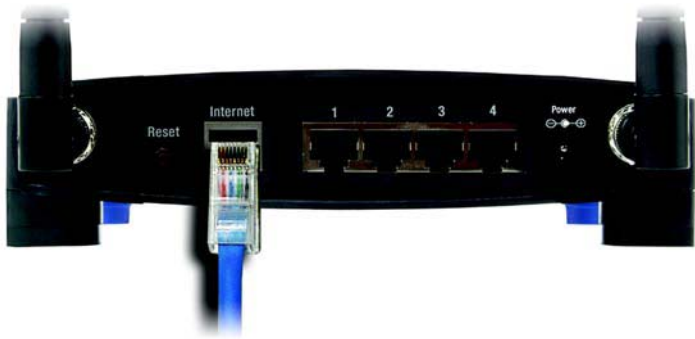
Figure 4-5 : Connexion d'un autre routeur
