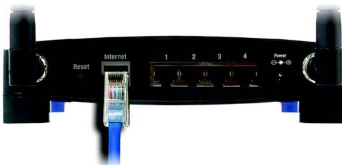
Figuur 4-5: Een andere router aansluiten
