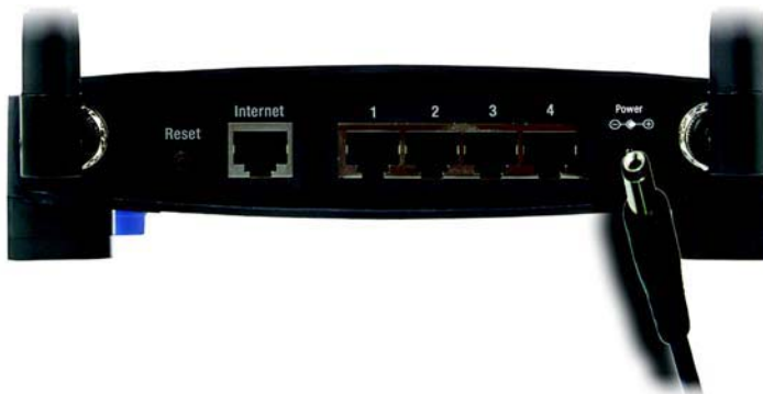
Figure 4-3 : Connexion de l'alimentation
