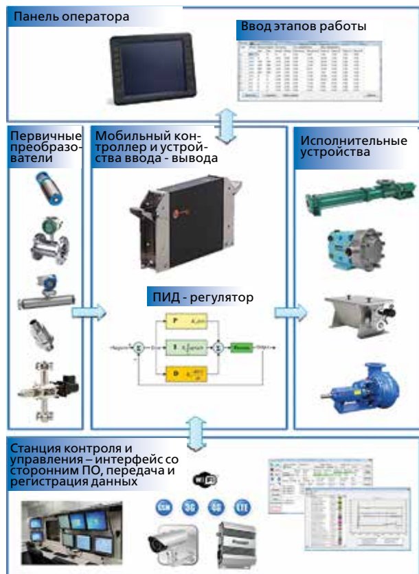
Рисунок 2 – Схема системы управления VisualFrac
