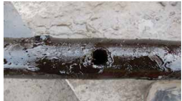
Рисунок 2 – Перфорационные заряды сработали полностью
