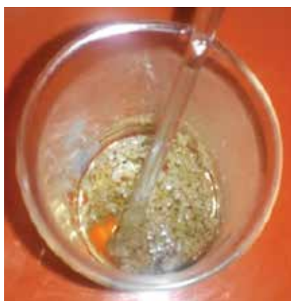
Рисунок 2 – Образец устойчивой эмульсии, которая образовалась при взаимодействии жидкости КРС с «неудачным» кислотным составом Figure 2 – A sample of a stable emulsion formed within well workover fluid interaction with «failed» acid composition
