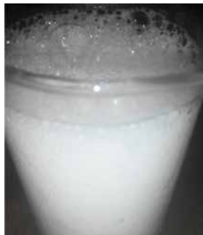
Рисунок 4 – Образец стабильной пены для проведения обработок в скважинах с высокой пластовой температурой до 150 °С
