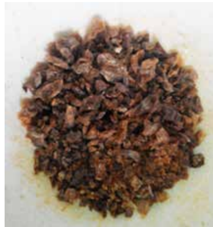
Рисунок 1 – Образец деградировавшей полимерной пленки на основе ксантана
