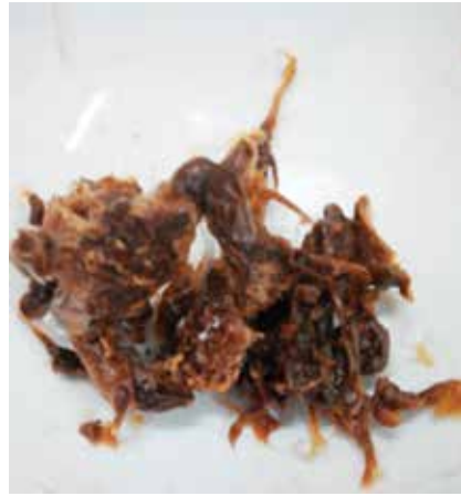
Рисунок 3 – Образец деградировавшего при условиях фильтрации бурового раствора
