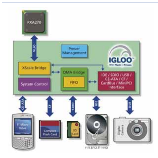
图 2. IGLOO™ 的应用结构图。
