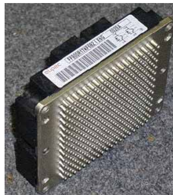
图 1. 英飞凌公司生产的直接液冷功率模块 (原型)。
