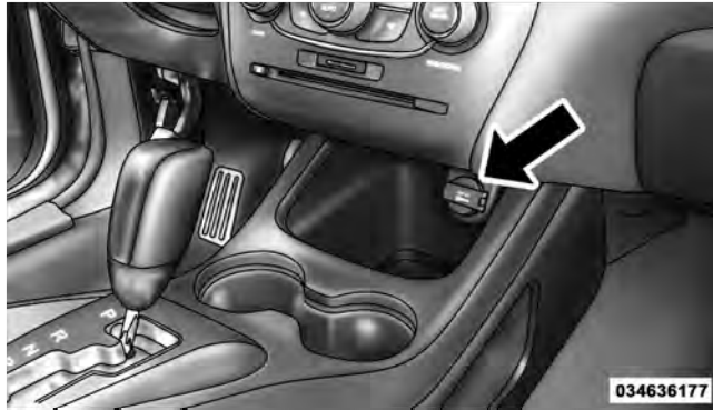
Front 12 Volt Power Outlet
