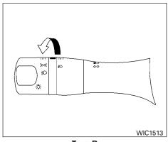
Type B FOG LIGHT SWITCH (if so equipped)
