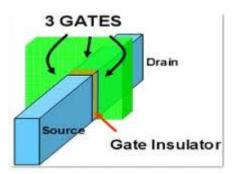
Figure4 : Trigate Structure
