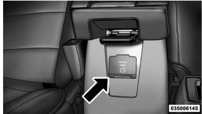
115 Volt Power Outlet
