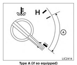
ENGINE COOLANT TEMPERATURE **GAUGE**
