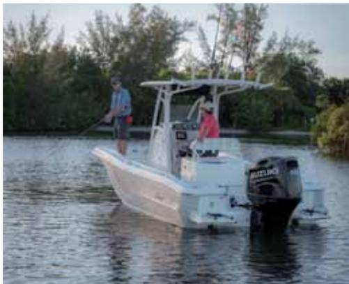
Los DF175AP y DF150AP están basados en un poderoso bloque de cuatro cilindros en línea DOHC con una cilindrada de 2.867 cm<sup>3</sup> el mayor hasta el día de hoy (\*) la categoría de cuatro cilindros en línea DOHC del mercado. Mientras la gran cilindrada permite tanto proporcionar una aceleración excepcional como velocidad, los ingenieros de Suzuki se han asegurado que las dimensiones finales sean lo más compactas y ligeras posibles.
