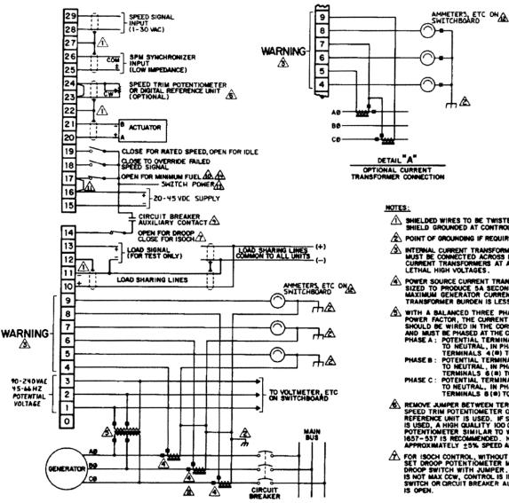
SHIELDED WIRES TO BE TWISTED PARS, WITH SHIELD GROUNDED AT CONTROL END ONLY.
