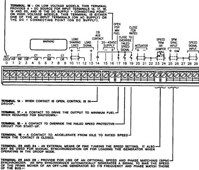
• DO NOT USE THE MINIMUM FUEL CONTACT OPTION AS PART OF ANY EMERGENCY STOP SEQUENCE. •• SEE REFERENCE TABLE FOR MORE INFORMATION ON SPM SYNCHRONIZERS.
