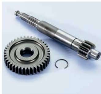
202.1378 Piaggio Z=13/40 Primary ratio-Primario
