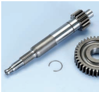
202.1405 Piaggio Zip SP 2000 Z=15/38 Primary ratio-Primario
