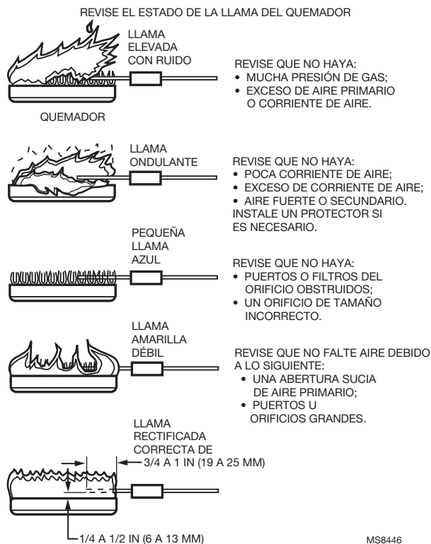
Fig. 5. Revisión del estado de la llama del quemador.
