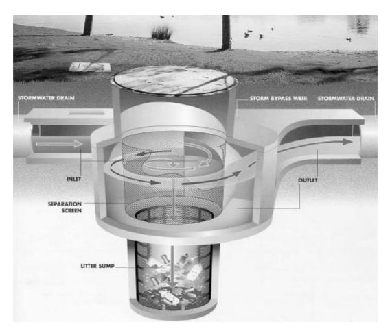
Figure 34.B3 CDS<sup>™</sup> Trap
