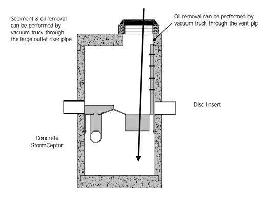
Figure 34.B2 StormCeptor<sup>™</sup> Trap
