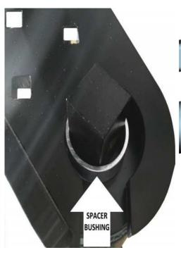
SLIDE THE BEARING OVER THE ROLLER SHAFT MAKING SURE THE RACE OF THE BEARING PROTRUDING OUTSIDE OF THE HOUSING FACES AWAY FROM THE ROLLER.
