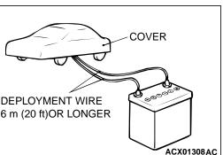
DEPLOYMENT OUTSIDE THE VEHICLE <Air bag module (driver's side)>
