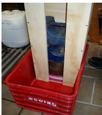
Fonte: Missão de Estudo da JICA Figura 7.3.4-3 Método de teste de compressão
