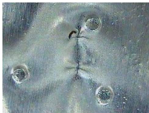
Figura 7.3.5-16 Ruptura e 3 ressaltos no lacre de alumínio melhorado.
