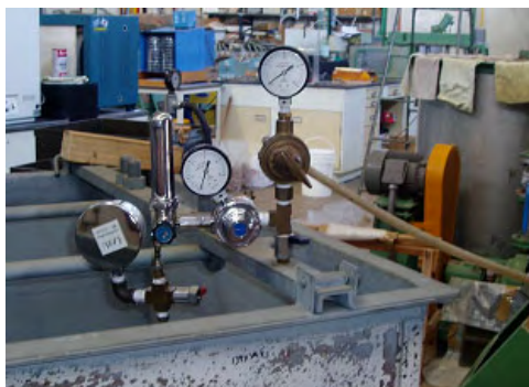
Figura 7.3.4-5 Equipamento de teste de estouro da LATU
