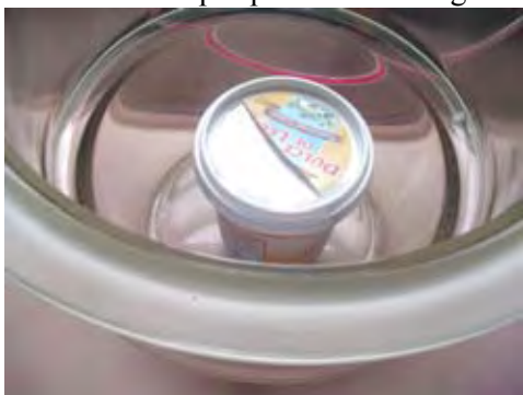
Figura 7.3.5-11 Afundamento do lacre de alumínio à pressão normal
