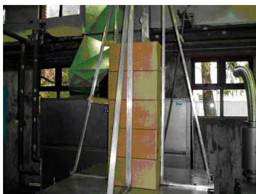
Figura 7.3.5-3 Teste de vibração na caixa inferior, com cinco caixas empilhadas
