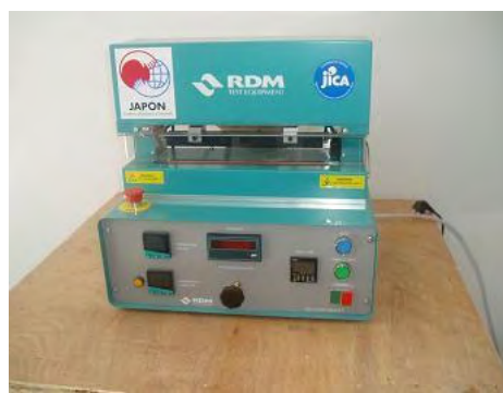
Figura 7.3.3-8 Teste de selagem a quente
