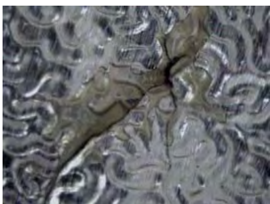
Figura 7.3.5-5 Microscopia da porosidade do lacre de alumínio
