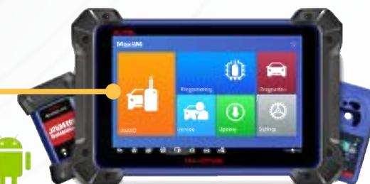
Este equipo es la herramienta de diagnóstico más completa de Autel con una pantalla de 10" táctil y su VCI con J2534 realiza las mismas tareas que un MS908 + las funciones avanzadas del IM508 para realizar las tareas de diagnóstico y programación a los sistemas con immobilizador de igual manera se puede codificar un transponder, aprendizaje de control remoto, mando a distancia, lectura y escritura de chip. Incluye programador de teclas XP400.
