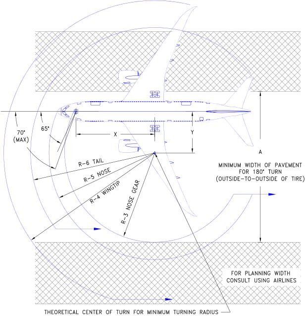
THEORETICAL CENTER OF TURN FOR MINIMUM TURNING RADIUS — SLOW CONTINUOUS TURNING AT MINIMUM THRUST ON ALL ENGINES. NO DIFFERENTIAL BRAKING. CONSULT USING AIRLINE FOR SPECIFIC OPERATING PROCEDURES.
