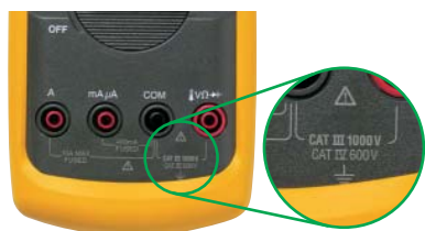
Používejte přístroje s těmito značkami: 1000 V CAT III nebo 600 V CAT IV
