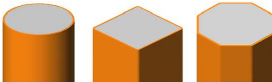
Fig.4.5 – Tipos de pilares mistos preenchidos [15]
