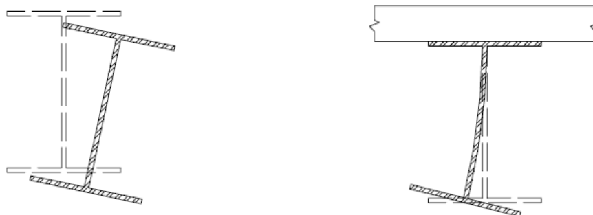
Fig.3.15 – Encurvadura lateral com torção, Instabilidade associada à distorção da secção transversal da viga de aço respectivamente [9]
