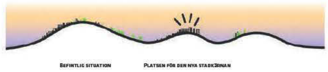
FÖRBÄTTAT MIKROKLIMAT För att adressera detta problem, använder vi själva landskapet som byggnadsmaterial för att utforma det optimala mikroklimatet. Genom att återanvända en resprodukt från gruvnäringen, stenkross, skapar vi en kulle på platsen för den nya stadskärnan och en sydslutning som skyddar staden från vind.
