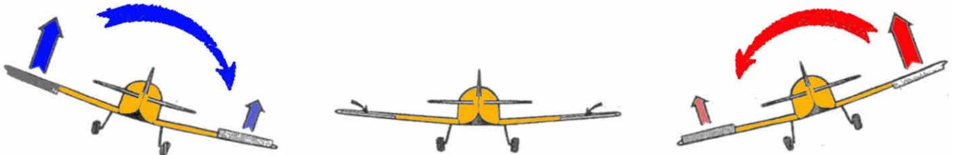
On **baisse** l'aileron du côté où il faut **augmenter** la portance et on le **lève** du côté où il faut la **diminuer**.
