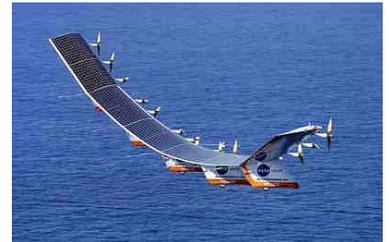
La recherche d'une traînée minimale et d'une portance optimale passe parfois par des ailes de grand allongement.
