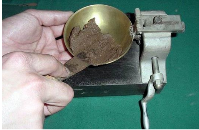
Figura 29. Ensaye de Copa de Casagrande para la obtención de límite líquido (Fuente: propia).
