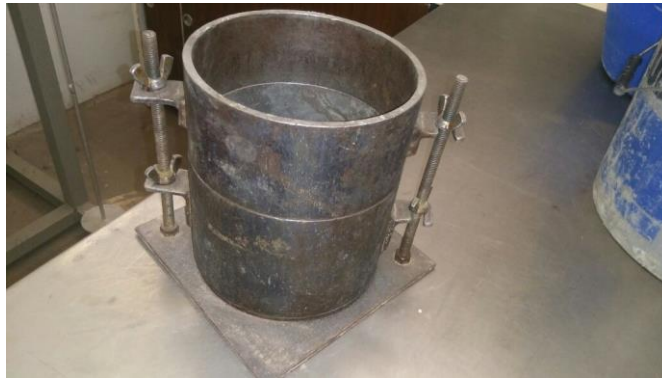
Figura 32. Equipo especializado para realizar ensaye de proctor estándar (Fuente: propia).
