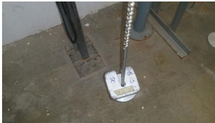
Figura 37 Ensayo de expansión para identificar la carga que abate la expansión sobre el terreno natural, colocación de la carga de sitio (Fuente: propia).
