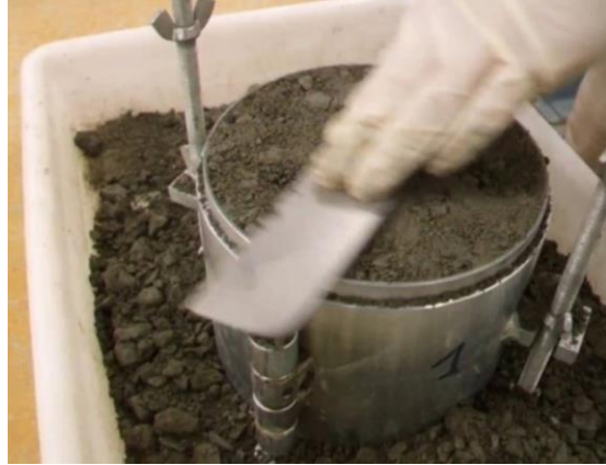
Figura 34. Enrase del molde con el objetivo de realizar el ensaye de compactación Proctor estándar (Fuente: propia).
