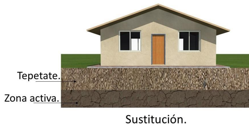
Figura 23. Método de sustitución el cual consiste el cambiar el material expansivo por un material inerte. (Fuente: Propia).
