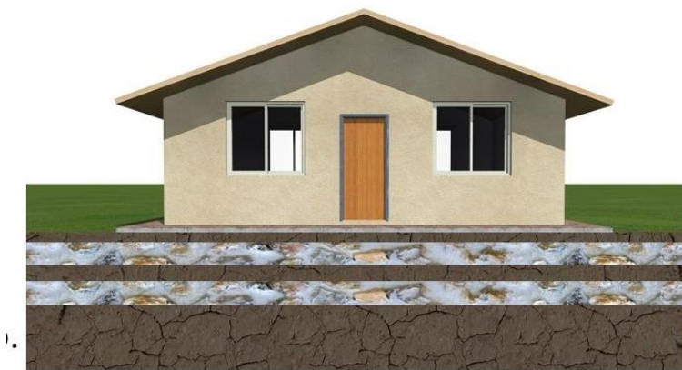
Figura 21. Estabilización con agentes químicos como la cal para estabilizar el medio y con ello abatir la expansión (Fuente: Propia).
