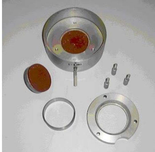
Figura 35. Elementos que integran el consolidómetro para realizar el ensaye de expansión libre (Fuente: propia).
