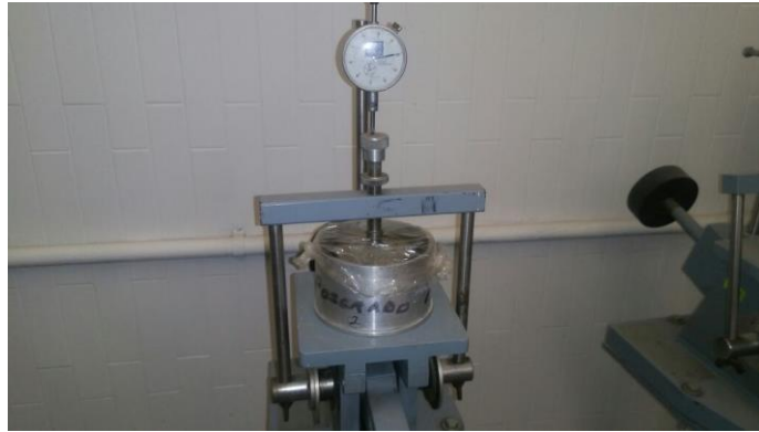
Figura 38. Ensayes de las muestras dosificadas con cal y con aplicación de carga (Fuente:propia).
