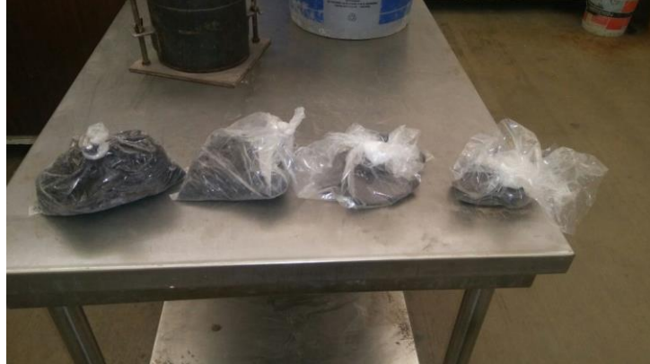
Figura 30. Muestras de material en bolsas de distintos contenidos de porcentaje de cal (2, 4 y 6% respecto al peso seco) (Fuente: Obtención propia).
