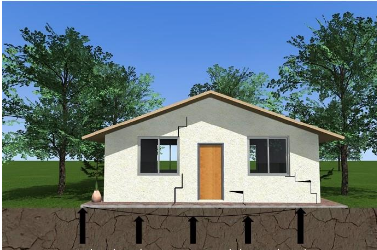
Figura 16. Agrietamiento de la estructura por movimiento perimetral provocada por la expansión de la arcilla (Fuente: Propia).
