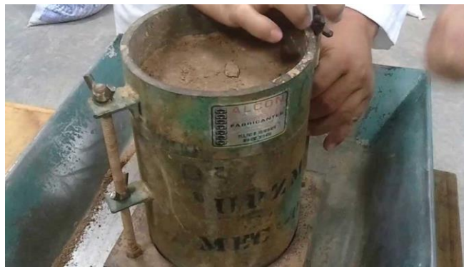
Figura 33. Colocación del material arcilloso en el molde de compactación (Fuente: propia).
