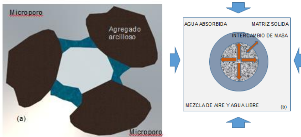
Figura 6. a) Macro estructura de un suelo arcilloso no saturado; (b) representación conceptual que demuestran los posibles mecanismos de deformación (Fuente: Lei et al, 2014).
