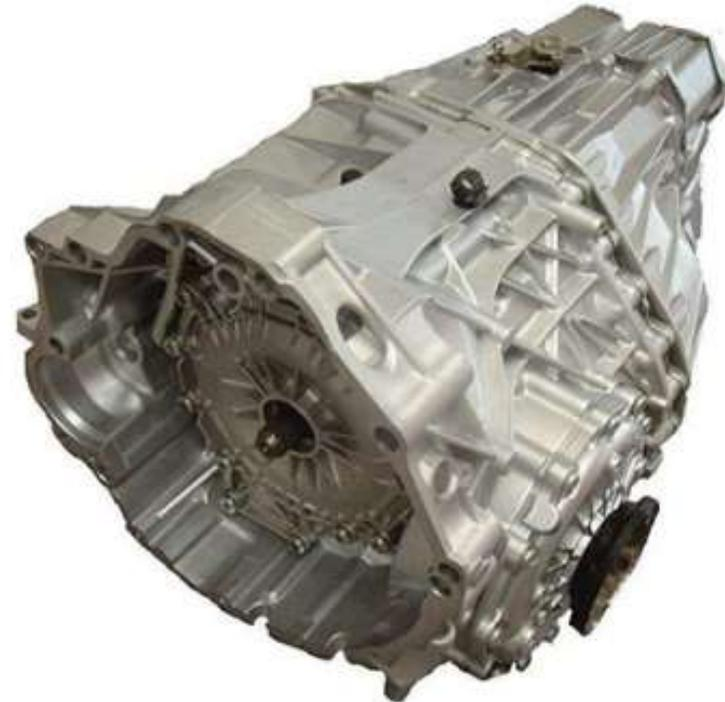
Eseguire il controllo livello olio cambio automatico con il motore acceso.
