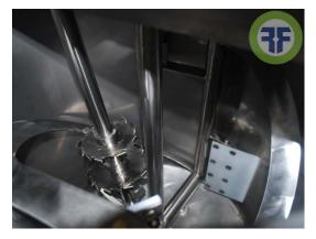
DUAL SHAFT SANITARY MIXING SYSTEM - INTERIOR
