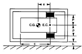
FIGURE 37 COUPLED FLAT SIDE DROP
