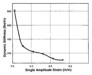
FIGURE 34 STIFFNESS VERSUS STRAIN— TYPICAL SPE®I ELASTOMER
