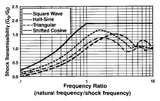
FIGURE 20 SINGLE DEGREE OF FREEDOM SYSTEM RESPONSE TO VARIOUS SHOCK PULSES
