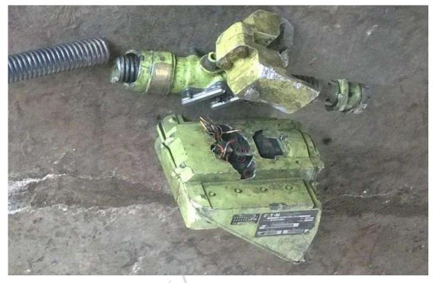
Fig. 24. The stab trim motor elements
