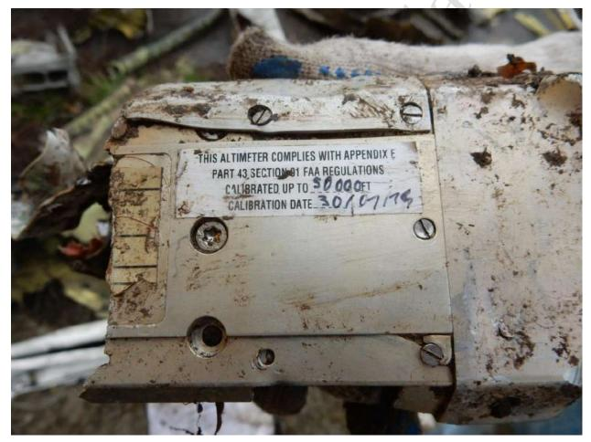
Fig. 29. The standby altimeter
