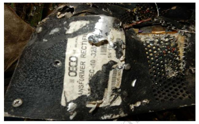
Fig. 20. The transformer-rectifier unit
