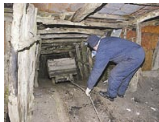
Veinticinco metros se interna en línea recta el socavón en la tierra. Después, dobla a la izquierda 150 metros hasta la veta de carbón.
