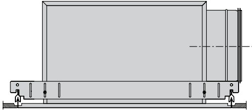
Liitäntälaatikko H mukaan lukien asennusosat PBB
