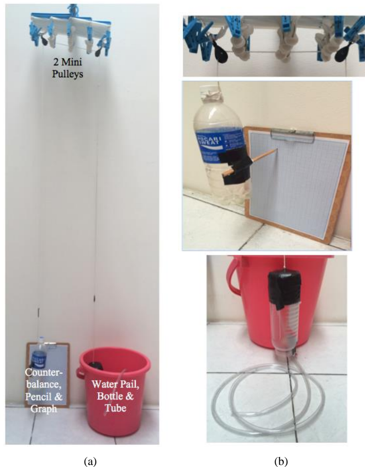
Gambar 5. (a) Setelan keseluruhan. (b) Atas: dua katrol mini, Tengah:imbangan, pensil dan papan jepit dengan kertas graf, Bawah: Botol dengan selang panjang
