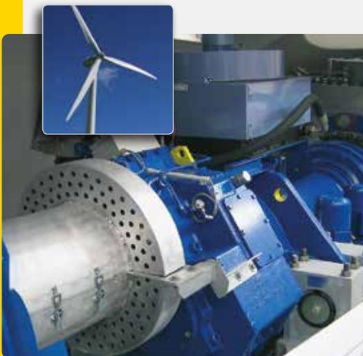
Easy-Laser® permite alinear generadores y cajas de engranajes de turbinas eólicas de distintos tamaños y fabricantes. El sistema se puede equipar con soportes especiales para efectuar la alineación con los rotores bloqueados, lo que incrementa la seguridad del operario.
