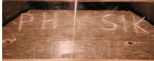
Abb. 13. In eine Plexiglasplatte ist (unten) das Wort »PHYSIK« gepunktet dargestellt. Um jeden Punkt als Zentrum wurde ein Kreis geritzt, von dem bei Beleuchtung mit einer Punktlichtquelle die Teile aufleuchten, die das an den Flanken des Ritzes reflektierte Licht ins Auge senden. Da jedes Auge ein geringfügig verschobenes Reflexionsmuster wahrnimmt, scheint das Wort im Raume zu schweben und sich die Lage mit dem Blickwinkel zu verändern.
