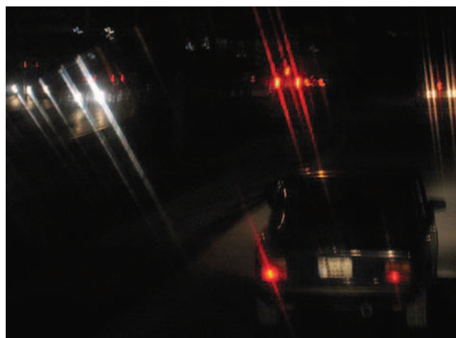
Abb. 12. Blickt man durch die Windschutzscheibe auf die Leuchten anderer Kraftfahrzeuge, so erscheinen senkrecht zu den Riefen in der Frontscheibe orientierte Lichtschweife, die zuweilen wie von der Lichtquelle zum Auge ragende Lichtbalken im Raume zu schweben scheinen.
