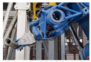
Figure 30: Robotic Roughneck<sup>70</sup>
