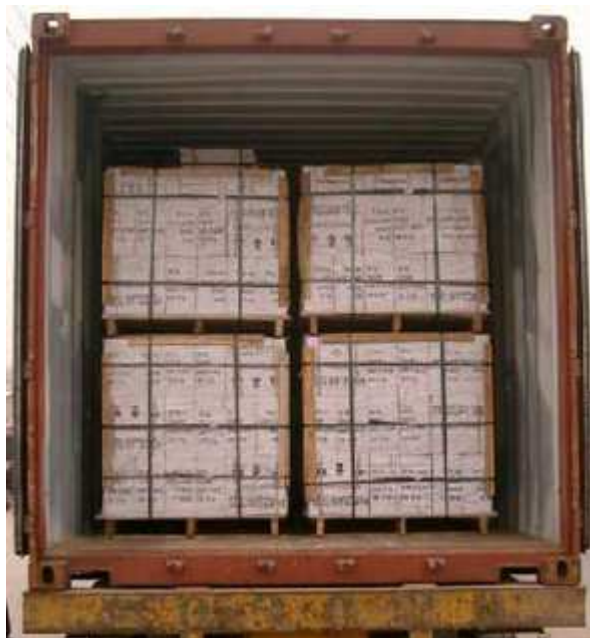
Fig.04 Mercancía paletizada cargada en contenedor. Fuente: Uship
