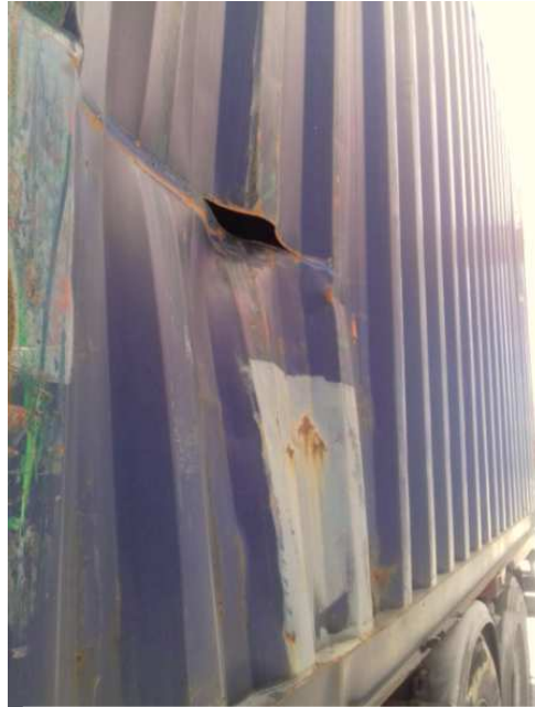
Fig.32 Contenedor dañado, raja y abolladura lateral. Fuente: Propia
