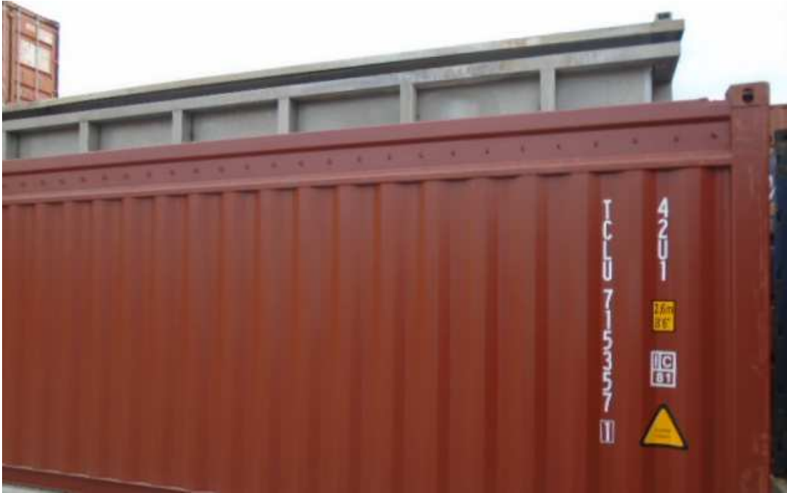
Fig.21 Contenedor Open Top con extramedidas (OOG). Fuente: Propia
