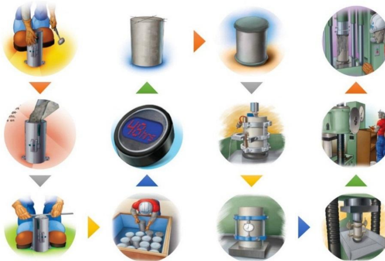
Figura 11. Procedimiento para la determinación del módulo de elasticidad estático y relación de Poisson
