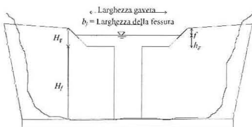
60 Fig. 5 : prospetto di una briglia aperta con l'indicazione delle principali grandezze di progetto.
