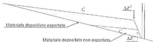
Fig. 9 - Profili longitudinali del deposito prima (apice I) e dopo (apice II) l'autopulizia con portata liquida inferiore a quella massima.
