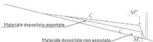
Fig. 10 - Profilo del deposito nel caso in cui il profilo dopo l'autopulizia incroci quello del deposito pieno.
