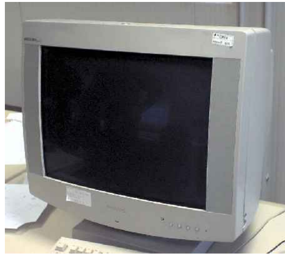
Figura 9: Monitor CRT, in via di estinzione...
