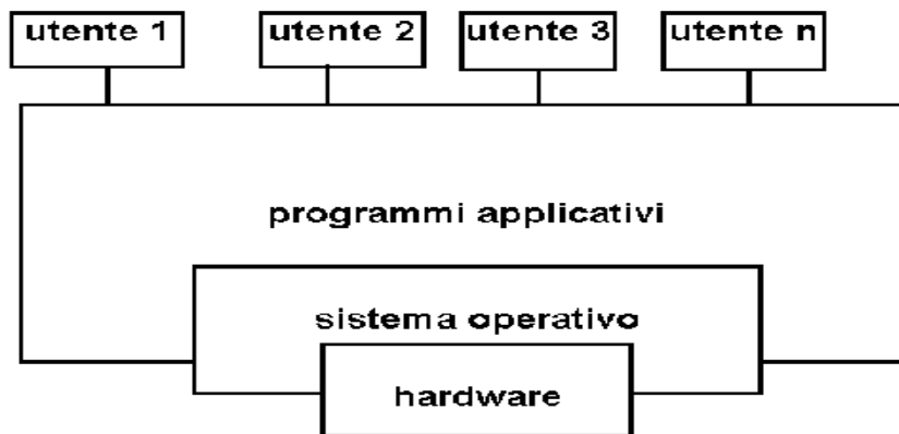
Figura 22: Il sistema operativo "nasconde" l'hardware agli utenti e crea l'ambiente di esecuzione per i programmi applicativi.
