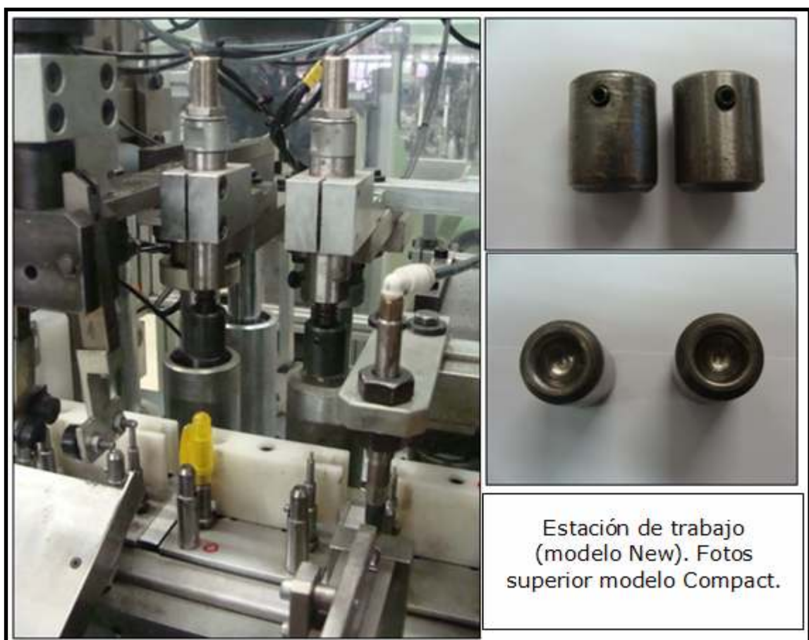
Fig. 5.14. Utillajes clavada tapón en estación de clavado.
