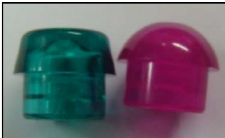
Fig. 5.8. Tapón mecanismo modelo New (verde) y modelo Compact (rosa).
