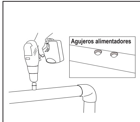
Figura 8. Perforación de agujeros alimentadores
