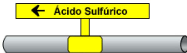
Cuando la tubería es de diámetro menor que 3/4 pulg, se le fija un aviso externo como este para indicar el contenido y la dirección.
